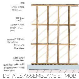
DÉTAILS ASSEMBLAGE ET MOB
